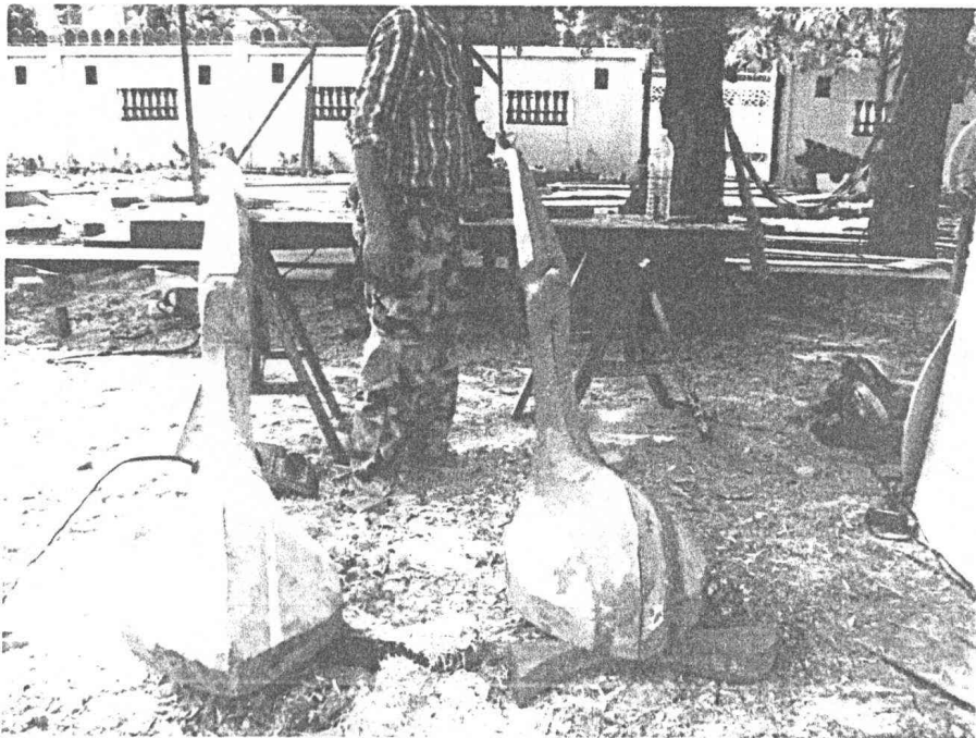
ภาพที่ ๓.๖๕ การกะสวนแบบช่อฟ้า, ใบระกาและหางหงส์ มาตรฐาน ๑:๑
