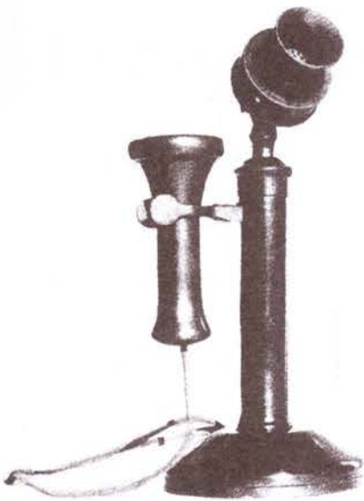
โทรศัพท์สมัยแรก ปากพูด-หูฟัง แยกจากตัวเครื่อง
