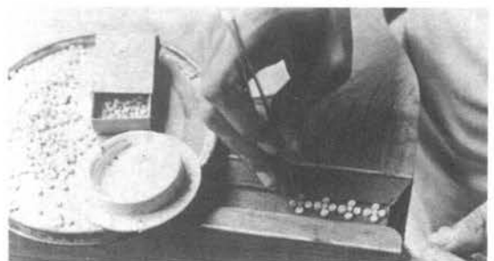
นำชิ้นหอยมุกที่ถูเป็นลาวตามต้องการแล้วติดลงไปกับภาชนะหรือวัตถุ
