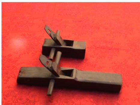
เต่าอง เป็นเครื่องซ่างไม้ ที่ทำด้วยไม้เนื้อแข็ง ประเภทไม้ชิงชัน มีใบเป็นเหลือกอย่างดี ใช้ในการไส และเหลาไม้ของซ่างไม้พื้นบ้าน หรือ สล่า กบไม้นี้ มีด้วยกันหลายขนาด และหลายชนิด ไม่ว่าเป็นขนาดสั้น ยาว และตลอดจนถึงใช้ประเภทม้าใบ ทำเป็นม้าไส ตกแต่ง ส่วนโถง ของไม้ และตลอดจนถึงใช้ประดิษฐ์ สร้าง แปঁง อุปกรณ์ เครื่องมือ ทำการเกษตร และงานหัตกรรมพื้นบ้าน
